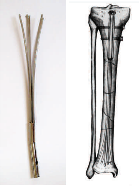
Şekil 10: Marchetti Vicenzi çivisi. Oymasız olarak yerleştiriliyor ve kilitleme distal ucu oluşturan tellerin kendiliğinden açılması ile sağlanıyor. Ancak iyileşme sonrasında çivinin çıkarılmasının çok zor olduğunu tahmin etmek mümkün.
